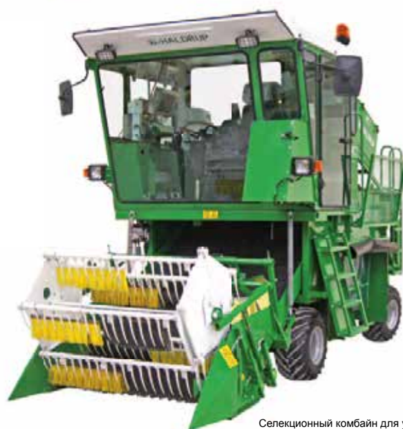
Селекционный комбайн для уборки многолетних трав и силосных культур HALDRUP F-55
